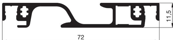
**Poignée standard** avec hauteur échelon **entre 800 mm et 1100 mm**
