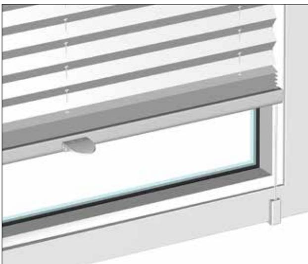
Montage sur châssis avec clip pour fenêtre, sans perçage ni vissage.
