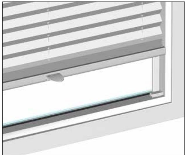
Montage avec set adhésif directement sur la vitre, sans perçage ni vissage, détachable sans laisser de résidus.
