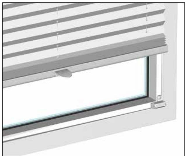
Avec une parclose plus étroite (p.ex. triple vitrage), le support de parclose peut également être utilisé pour un montage frontal sur le châssis de fenêtre.
